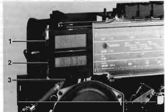
Bild 9 Rastnasen der Uhrbefestigung / Lämpchenwechseln
